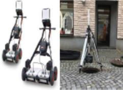
Rilievo topografico delle prementi con ausilio di tecniche georadar e con tecnologia laser scanner 3D degli impianti idrici
